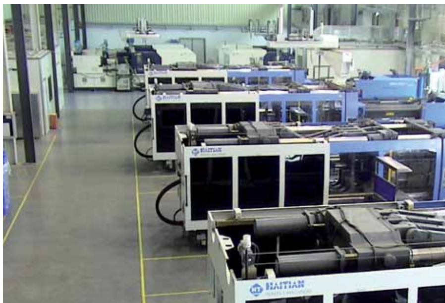
Division 3: 200 Spritzgießmaschinen von Haitian International sind installiert.
