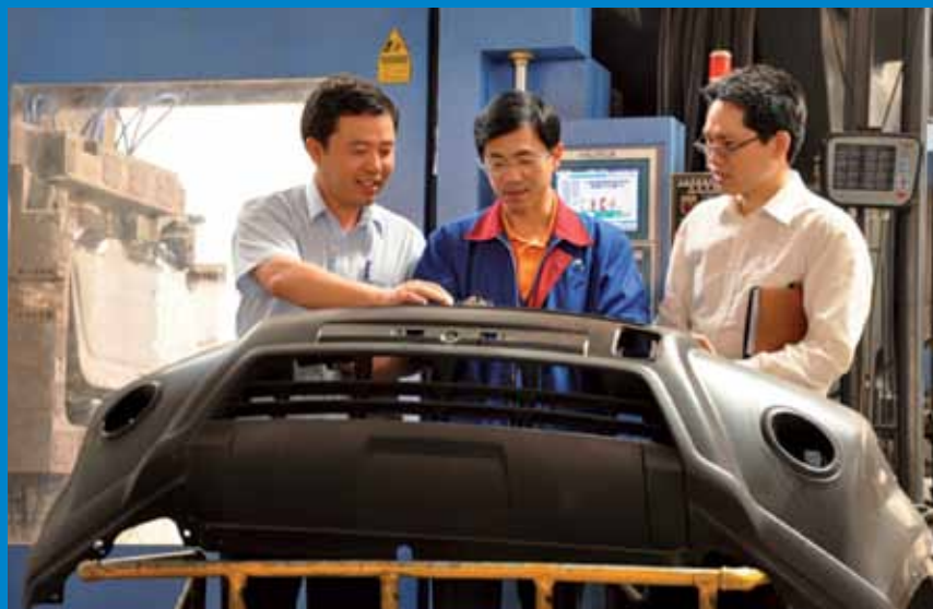
Von links: Herr Guo, Herr Ryan Huang (Vizepräsident) und Herr Luare prüfen eine Stoßstange, produziert auf einer Haitian Jupiter Serie mit 3.300 Tonnen.
