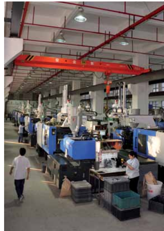
140 Haitian und Zhafir Maschinen zwischen 60 bis 530 Tonnen laufen 24 Stunden am Tag, 7 Tage pro Woche und 50 Wochen im Jahr.
