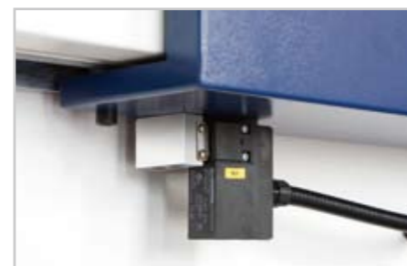
安全性に対するコンセプト 操作側と反操作側の安全ドアには、ソレノイドインターロックが装置され、可動プラテンが停止している時のみ、開放可能となります。
