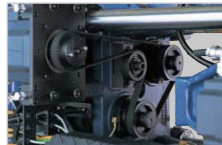
正確性とバランス 2本のボールスクリーュー駆動により、精度0.01mmの突出し動作を提供します。
